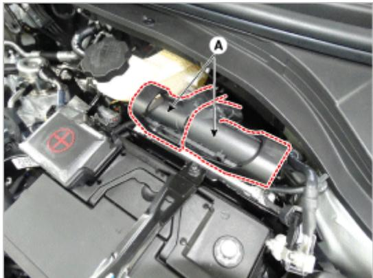
4. 拧下装配螺栓(A)，拆卸ECM支架(B)。
