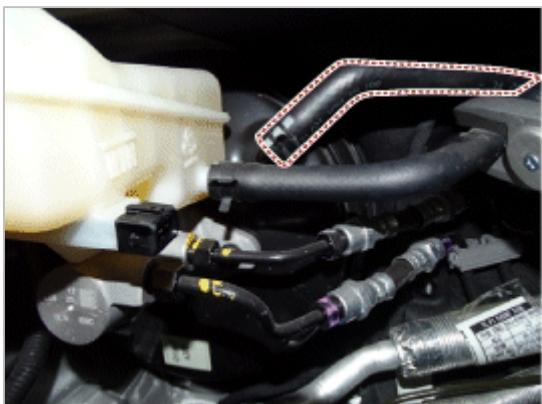
4. 使用注射器吸出主缸储油罐内的制动油。
